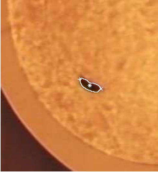
Рис. 1. Пример работы системы трекинга одной мыши в клетке. Белым показан выделенный контур мыши. Также отмечены найденные ключевые точки: звездочкой — центр масс, плюсиком — нос, крестиком — хвост.
