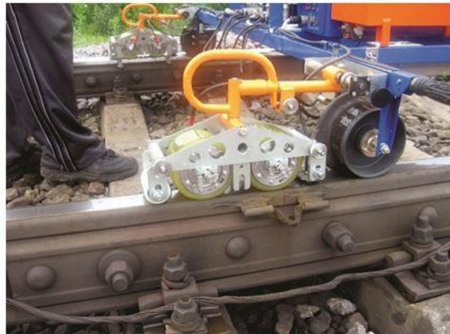
Современный съемный двухниточный дефектоскоп АВИКОН-14
