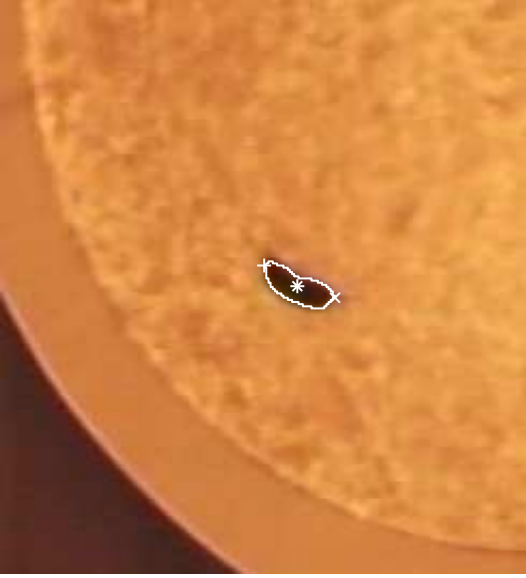
Рис. 1. Пример работы системы трекинга одной мыши в клетке. Белым показан выделенный контур мыши. Также отмечены найденные ключевые точки: звездочкой — центр масс, плюсином — нос, крестиком — хвост.
