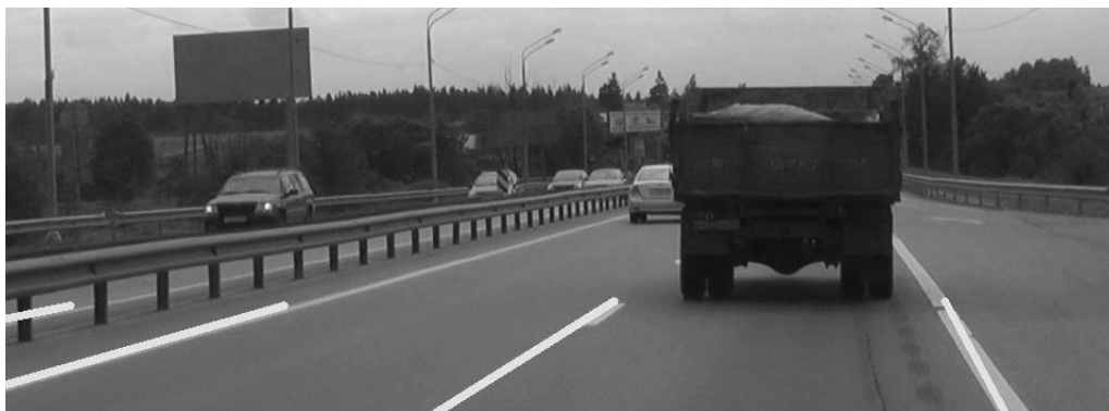
Рис. 2. Изображение с выделенными линиями разметки после выполнения алгоритма
