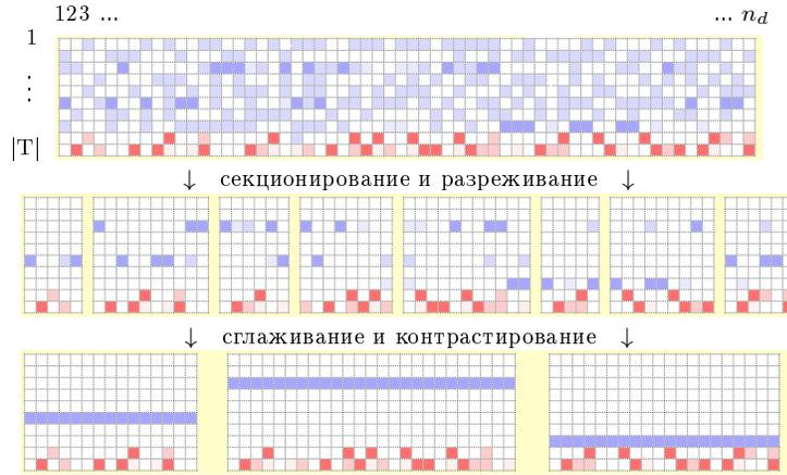
Рис. 23: Эвристическая пост-обработка E-шага для выделения тематически однородных сегментов текстового документа  $d = \{w_1, \dots, w_{n_d}\}$  длины  $n_d$ . Фоновые темы не участвуют в пост-обработке.
