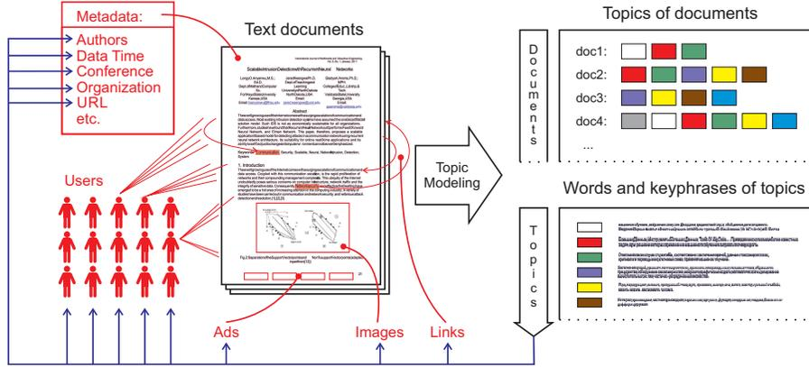
Рис. 12: Обычная тематическая модель определяет распределение тем в каждом документе  $p(t|d)$  и распределение термов в каждой теме  $p(w|t)$ . Мультимодальная модель распространяет семантику тем на элементы всех остальных модальностей, в том числе нетекстовые.
